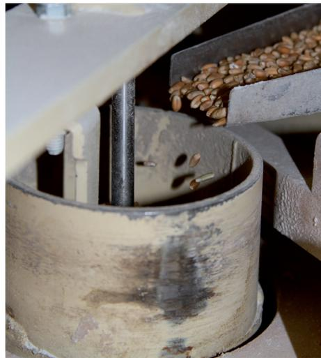
Astré-Mühle – Innerhalb einer Minute wird aus dem Korn feines Mehl. Foto: Sonja Korspeter
